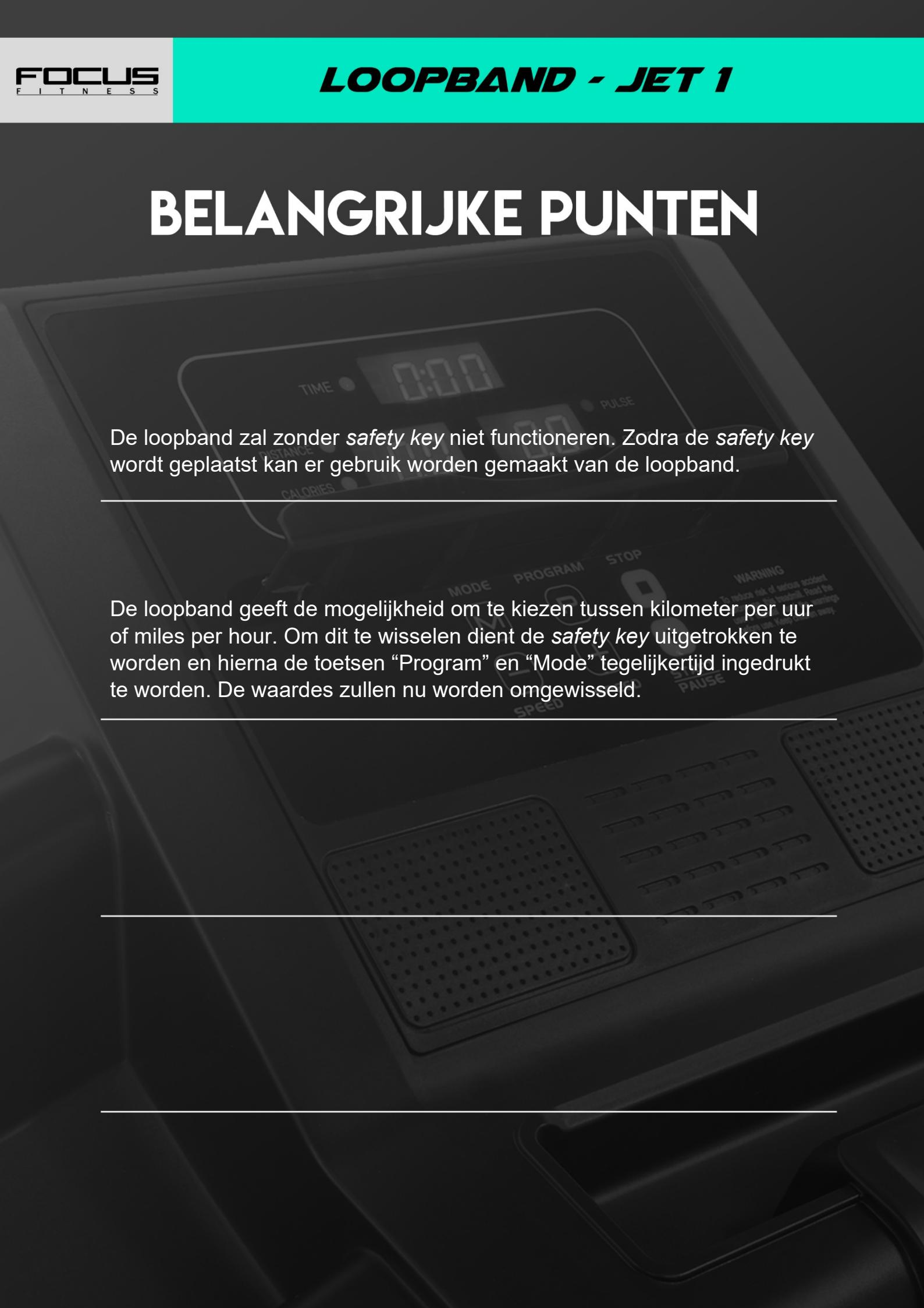
De loopband zal zonder *safety key* niet functioneren. Zodra de *safety key* wordt geplaatst kan er gebruik worden gemaakt van de loopband.
